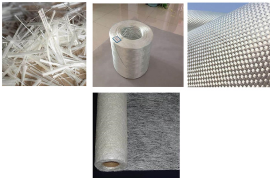
(a) Chopped strand (b) Direct draw roving (c) Woven mat (d) Chopped strand mat
