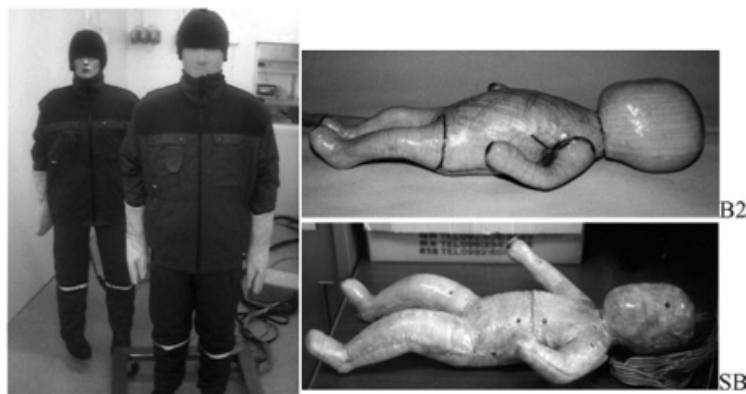
Figure 3: Lady, Tore and Baby thermal manikins (Kuklane et al., 2004).
